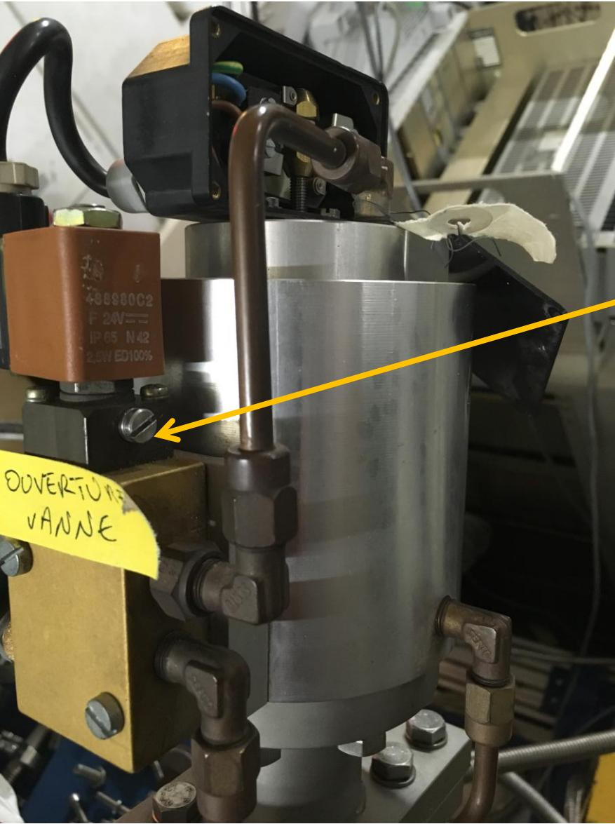
Vis ouverture/fermeture de vanne
